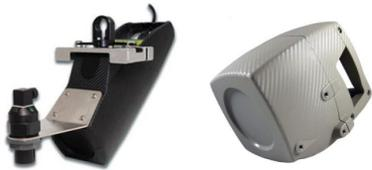
Caudalímetro que se instala por encima de la superficie del agua y mide la velocidad del flujo utilizando la tecnología de radar y el nivel del agua empleando un sensor de nivel (ultrasónico, radar o piezoresistivo).
