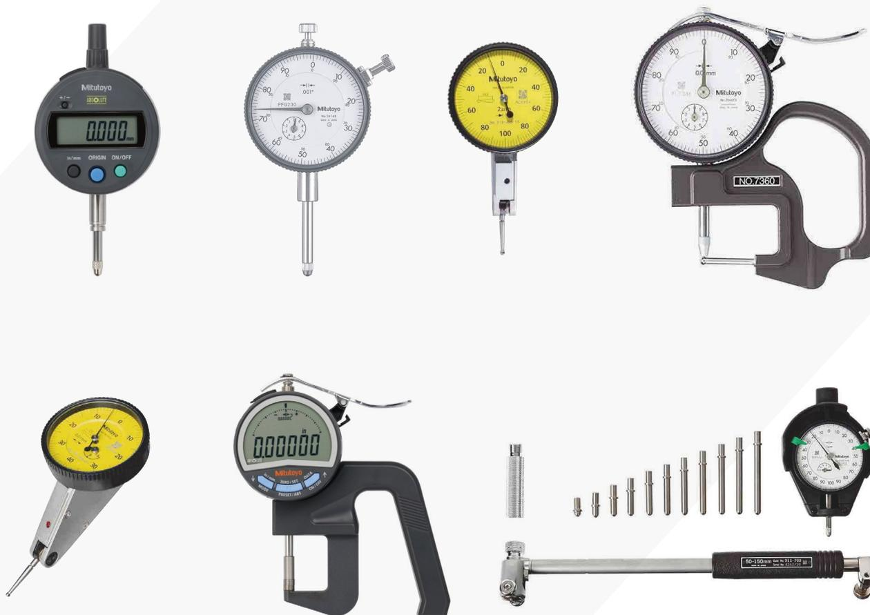
La calibración de medidores de espesores e indicadores se realiza por comparación directa, usando como referencia documentos normativos como **JIS B 7503** Mechanical dial gauges y la **ASME B89.1.10M** Dial indicators (for linear measurement), verificadores de diámetros internos usando la **JIS B 7515** Cylinder gauges y los palpadores a través de la **JIS B 7533** Dial test indicators (lever type) y la **ASME B89.1.10M** Dial indicators (for linear measurement).
