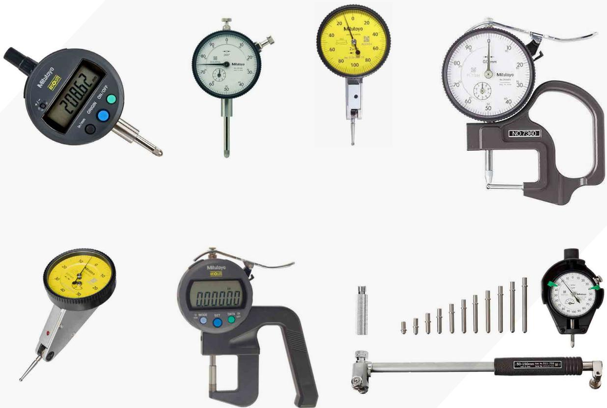
La calibración de medidores de espesores e indicadores se realiza por comparación directa, usando como referencia documentos normativos como JIS B 7503 Mechanical dial gauges y la ASME B89.1.10M Dial indicators (for linear measurement), verificadores de diámetros internos usando la JIS B 7515 Cylinder gauges y los palpadores a través de la JIS B 7533 Dial test indicators (lever type) y la ASME B89.1.10M Dial indicators (for linear measurement) digitales y análogos.
