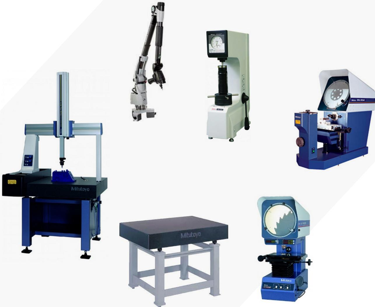
La calibración de superficies se realiza por comparación directa, usando como referencia la norma JIS B 7513, proyector de perfiles a través la JIS B 7184, las máquinas de medición por coordenadas bajo la ISO 10360-2, los brazos de medición con la ASME B89.4.22 y los durómetros a través de comparación indirecta con la norma ASTM E18.
