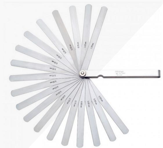
La calibración de las galgas de espesor se realiza bajo comparación directa usando la norma JIS B 7524 Feeler gauges y los filmes de espesor usando el instructivo interno LM-I-14.
