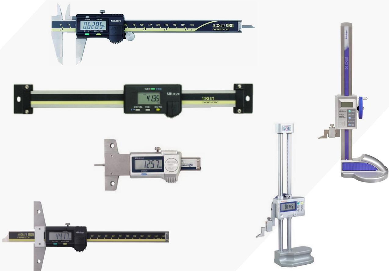
La calibración de pie de rey y escalas lineales se realiza por comparación directa, usando como referencia documentos normativos como JIS B 7507 Vernier, dial and digital callipers, los medidores de profundidad bajo la JIS B 7518 Vernier, dial and digital depth gauges y los medidores de altura a través de la JIS B 7517 Vernier, dial and digital height gauges.
