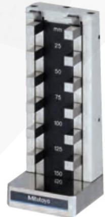
La calibración del bloque patrón se realiza por comparación mecánica, usando como referencia la norma ISO 3650 y el instructivo LM-I-40, los maestros de longitudes fijas a través del instructivo interno LM-I-30 y los calibradores de indicadores bajo el LM-I-31.
