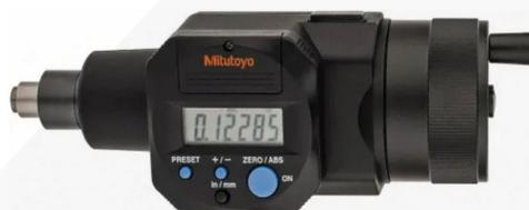
La calibración de cabezas micrométricas se realiza por comparación directa, usando como referencia el documento JIS B 7502 Micrometers.
