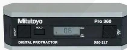
La calibración de escuadras se realiza por comparación directa, usando como referencia la norma JIS B 7526 Squares, los niveles de precisión bajo la JIS B 7510 precision levels y los goniómetros e inclinómetros a través del procedimiento DI-003 para la calibración de transportadores de ángulos del CEM.
